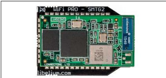
1 – присоединение антенны к модулю беспроводной передачи данных WiFi (выполняется при отсутствии встроенной в модуль антенны)
